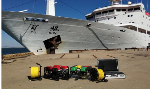
图 1：船体检测水下机器人
